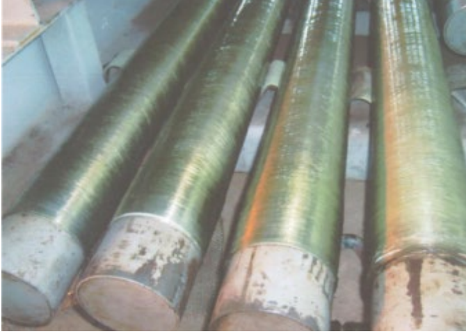
Şəkil 2. Xarici səthi kompozit plastik üzlüklərlə izolyasiya olunmuş polad boruların ümumi görünüşü
